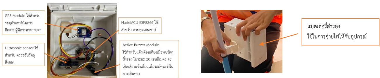
ภาพ 1 การติดตั้งเซนเซอร์ต่าง ๆ ลงในกล่อง เพื่อทำการเชื่อมต่อเว็บไซต์การใช้เทคโนโลยี IoT สำหรับผู้พิการทางสายตา
